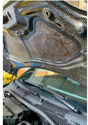
Non mancano esempi di compositi strutturali, bio-based e riciclabili, progettati per applicazioni di carrozzeria come il cofano, formulati con resine derivate da biomasse e realizzati nell'ambito del progetto C2CC, che si è occupato di ingegnerizzare la produzione dei semilavorati e sviluppare il processo di riciclo e conformità con i requisiti dell'industria automobilistica.
