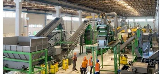
Stena Recycling rivendica la capacità di bonificare, tritare e separare tutte le tipologie di RAEE, arrivando a produrre 'End of Waste' di metalli ferrosi, metalli non ferrosi, vetro e plastica, recuperando in questo modo oltre l'80% di ogni prodotto trattato.
