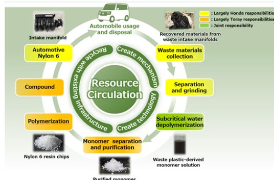
La tecnologia allo studio prevede la depolimerizzazione del nylon mediante l'utilizzo di acqua subcritica, ottenendo al termine del processo un monomero, il caprolattame, riutilizzabile per la sintesi di nuove poliammidi.
