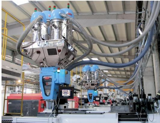
Il dosaggio è una delle fasi cruciali nei processi di trasformazione delle materie plastiche da condizionare nel bene o nel male la qualità delle prestazioni del prodotto finito. È in questa fase, infatti, che le resine, i pigmenti e gli additivi vengono alimentati alle macchine talvolta in percentuali minime, non di rado nell'ordine di pochi grammi. Si capisce che precisione e costanza sono aspetti fondamentali nella scelta di questo componente del sistema di alimentazione.
