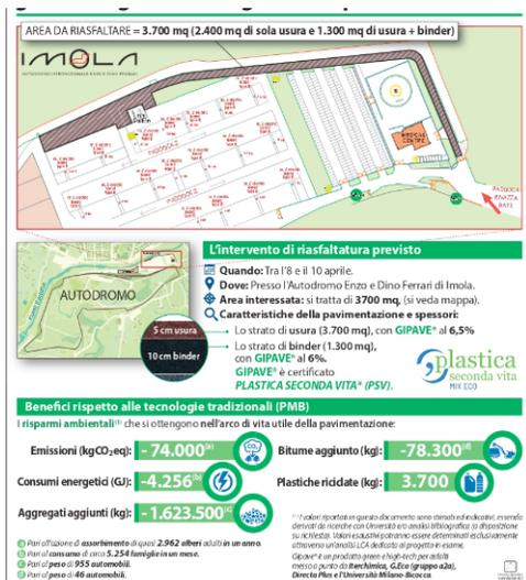
Gipave è stato impiegato per lo strato di usura di 5 cm (per 3.700 m<sup>2</sup>) e per lo strato di binder di 10 cm (1.300 m<sup>2</sup>). In entrambi i casi è stato utilizzato il 15% di "fresato" derivante dalla demolizione di vecchie pavimentazioni insieme a sabbia di recupero da scorie.
