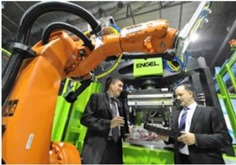
La Facoltà di Tecnologia delle strutture leggere e lavorazione delle materie plastiche del Politecnico di Chemnitz, in Germania, ha installato presso i propri laboratori un'isola di produzione con tecnologia Organomelt di Engel per lo stampaggio ad iniezione di componenti strutturali fibrorinforzati.
