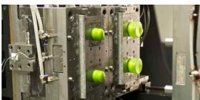
Due isole per imballaggio. Per applicazioni di packaging, invece, Engel proporrà in Fiera una soluzione che fonde cicli brevi (4 secondi) e risparmio energetico, sfruttando le prestazioni della pressa elettrica e-motion 740/200 T, equipaggiata con uno stampo Schmittli a 4 impronte per coperchi in polipropilene destinati al packaging alimentare. Grazie al sistema di etichettatura nello stampo (IML, fornito da Star Automation Europe), i pezzi escono dalla macchina già decorati e pronti all'uso.
