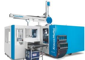
L'allestimento prevede una pressa GX 450-3000, con forza di chiusura di 450 tonnellate, in configurazione CellForm per la schiumatura fisica dei componenti, mediante tecnologia MuCell di Trexel, che in fiera produrrà un porta telefono per auto.
