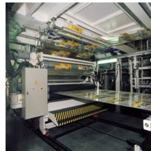
La linea, con larghezza netta di 2.100 mm, è dotata di tre estrusori con teste di nuova generazione per un miglior controllo della planarità della lastra e maggiori prestazioni in termini di produttività e velocità, rispettivamente per alte e basse grammature.
