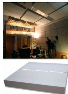
Il pannello assorbe le onde sonore, soprattutto alle medie ed alte frequenze, da 500 a 2.000 HZ, è antifiamma in classe A1 secondo la UNI 9177 (B1 secondo la DIN 4102) ed è in grado di illuminare gli ambienti sottostanti grazie alla completa integrazione di lampade a LED con durata utile di 30mila ore.
