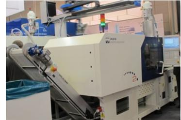
In mostra a Friedrichshafen tre isole di produzione: due per applicazioni medicali e una per packaging. Una Mercury da 100 tonnellate, pressa elettrica costruita in Germania dalla consociata Zhafir, produceva una pipetta in polipropilene con un tempo di ciclo di 9 secondi, utilizzando uno stampo a 64 cavità; i pezzi erano poi rimossi attraverso un robot Sepro.
