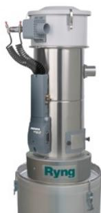
Ryng è un dispositivo universale che può essere montato su tutti i modelli e marche di caricatori. Utilizza un software proprietario con specifici algoritmi che gestiscono ed elaborano i dati raccolti, riportando la quantità reale di materiale trasferito.
