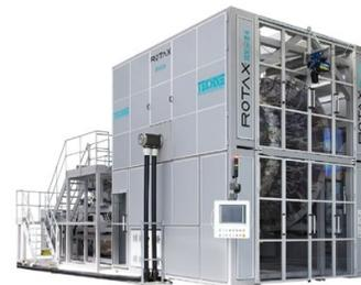
Dotato di 24 stazioni in configurazione a doppio parison e azionamento completamente elettrico, l'impianto è in grado di produrre in un'ora oltre 30mila bottiglie da 250 ml, anche se la gamma di contenitori che può essere soffiata è ampia: va dai piccoli contenitori con capacità di 250 e 500 ml - con un sistema di regolazione che consente di ridurre gli scarti - fino a taniche da 5 litri per uso alimentare, detergenza e oli lubrificanti.
