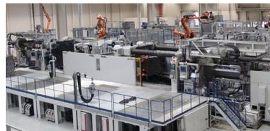
Particolarità delle celle di produzione è l'accoppiamento in tandem delle presse, allineate lungo il lato posteriore in modo da mettere in fase il ciclo di entrambe le macchine (modalità master/slave) e di produrre e completare due pezzi in simultanea.
