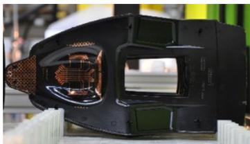
Il film "multiskin" sviluppato da Plastic Electronic si basa su uno o più strati elettrici depositati su un substrato in poliestere - PET o PEN (polietilene naftalato), oppure in policarbonato. I connettori per il collegamento con i componenti elettronici esterni possono essere integrati nel film come componenti SMD, oppure applicati durante il
