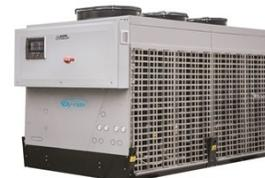
I refrigeratori monoblocco con condensazione ad aria sono stati progettati per installazione esterna, senza necessità di protezione. La potenza frigorifera è compresa tra 115 e 691 kW, in configurazione con evaporatori a piastre o a fascio tubiero, compressori Scrolli e gas R407c.
