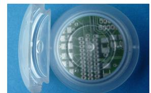
Si ottiene in questo modo una perfetta adesione sull'intera superficie di contatto e non solo lungo la linea di giunzione, quindi una sigillatura senza formazione del cordone di saldatura.
