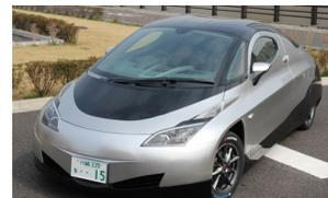
Il prototipo, il terzo sviluppato dal costruttore nipponico e come i precedenti perfettamente funzionante, monta motori elettrici direttamente sulle ruote. Pesa 1.580 kg, ha un'autonomia di oltre 350 chilometri e un'accelerazione da 0 a 100 km/h in soli 4,2 secondi, per una velocità massima di 180 km/h, prestazioni raggiunte anche grazie all'impiego di materiali leggeri.
