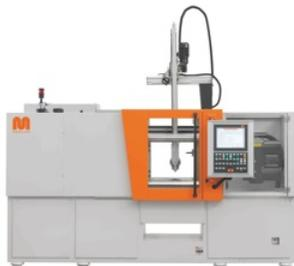
L'isola di stampaggio si basa su una pressa orizzontale made in Austria Maplan MHF700/300XL editionS (foto a sinistra) dotata di unità d'iniezione FIFO-Duale e stampo a 4x54 cavità dello stampista ORP Stampi con tecnologia a Canale Freddo (CRB, Cold Runner Block) a 4 ugelli (foto a destra), con il quale si possono produrre, in un unico ciclo, fino a 216 guarnizioni da 0,25 grammi ciascuna.
