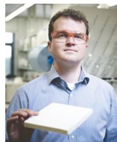
Si tratta di uno speciale aerogel a base poliuretanic in forma pannelli sottili che, a differenza delle tipologie già in commercio, garantirebbe buona resistenza meccanica, superando uno dei principali limiti di questa classe di materiali, sviluppati inizialmente per l'industria aerospaziale
