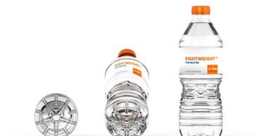
Nonostante il peso contenuto, la bottiglia garantisce un carico assiale superiore (top load) di 33 kg (+32%), senza riempimento con azoto, utilizzando chiusure standard da 26/22. La pressione di soffiaggio è intorno ai 20 bar.
