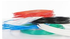
Nella produzione additiva, il materiale viene alimentato alla stampante 3D in forma di filamenti, che vengono fusi in una sorta di estrusore miniaturizzato; la resina viene quindi depositata, uno strato alla volta, sul piano di lavoro, fino a comporre l'oggetto tridimensionale.
