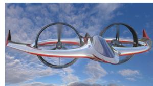
Project Zero, illustrato da Michael Robinson (ED Design) al convegno "Design e materiali compositi", è il primo convertiplano 100% elettrico ad ala rotante, senza pilota. Lungo 8 metri e largo 14, possiede una scocca monoblocco in composito rinforzato grafite, con telaio di alluminio.
