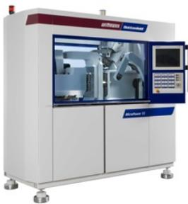
Una seconda pressa, MicroPower 15/10 (foto a sinistra), sarà dedicata al microstampaggio di precisione in condizioni di camera bianca: produrrà in Fiera un microfiltro per applicazioni medicali in POM, con una maglia di appena 80 micron e un peso di soli 1,1 milligrammi, con applicazioni nell'ingegneria acustica, pompe miniaturizzate e inalatori.
