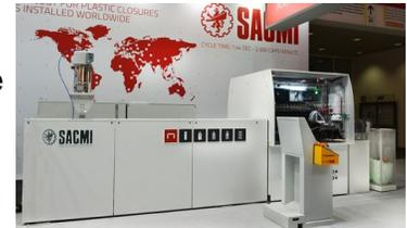
Si parte dalla produzione di tappi in plastica, con alcuni cavalli di battaglia come il sistema di stampaggio a compressione CCM a 32 cavità (foto a destra), quest'anno equipaggiato con lo stampo di ultima generazione 'COOL+' messo a punto per rendere il processo di raffreddamento ancora più efficiente. La CCM32 produrrà in fiera chiusure per bevande gasate con un tempo di ciclo vicino ai 2 secondi e qualità garantita grazie al sistema CVS3000 a due telecamere integrato nella linea.
