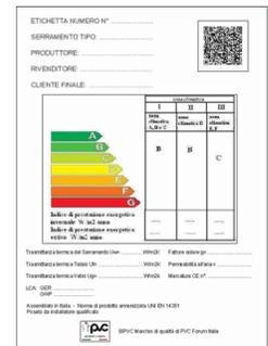
Oltre alla parte energetica, l'Etichetta proposta dall'associazione riporta il riferimento alla marcatura CE, all'assemblaggio, alla posa in opera, all'impatto ambientale (GER e GWP secondo LCA) e alle caratteristiche principali del serramento (trasmissione, fattore solare e permeabilità all'aria). Riporta inoltre i riferimenti al marchio volontario SIPVC oltre al numero progressivo, al tipo di serramento, al produttore, al rivenditore e al cliente finale.
