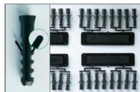
La tecnologia activeFlowBalance compensa le condizioni di pressione all'interno della cavità o tra le cavità dello stampo, evitando effetti negativi sulla stampata come flashing, mancato riempimento e danni allo stampo.
