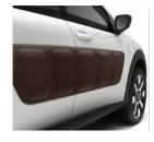
La protezione in TPU, disponibile in quattro diversi colori (nero, grigio, cioccolato e sabbia), viene applicato sulle porte laterali e in alcuni punti del fascione paraurti tramite clip e una vite di sicurezza. Ogni elemento può essere facilmente sostituito in caso di danni o, più semplicemente, se si vuole cambiare l'aspetto della carrozzeria. L'aggravio di peso per il veicolo è pari a circa 3,5 chilogrammi.
