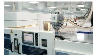
PureFlo è una nuova generazione di ricevitori di granulo, privi di filtro, destinati ad applicazioni in cui le operazioni di pulizia e manutenzione potrebbero rivelarsi critiche per la stabilità del processo, o nella movimentazione di materiali rinforzati, molto abrasivi. L'assenza del filtro, inoltre, migliora la capacità di trasporto dell'intero sistema, evitando le perdite di pressione.
