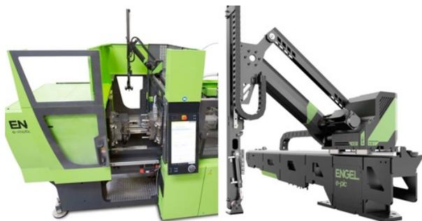
Tra le novità presentate quest'anno da Engel a Fakuma, spiccava anche il nuovo e-pic, robot compatto sviluppato per applicazioni di pick-and-place e smaterozzamento su presse con forza di chiusura fino a 220 tonnellate. Sistema che completa l'offerta di robot per stampaggio ad iniezione del costruttore austriaco, in risposta alla crescente domanda di automazione che proviene dalle imprese trasformatrici.
