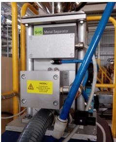
Il separatore di metalli Protector è installato prima dell'ingresso delle resine nei cilindri di plastificazione di presse, estrusori e macchine per il soffiaggio. L'apparecchio rileva tutte le particelle magnetiche e non magnetiche di metallo (acciaio, acciaio inox, alluminio) anche se sono incorporate nel prodotto. I contaminanti metallici vengono poi rimossi dall'unità di espulsione Quick-Valve.
