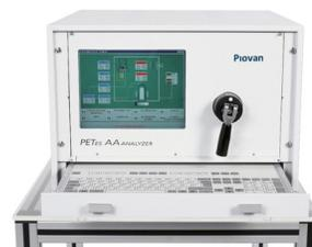
Lo strumento consente di misurare il tenore di acetaldeide sull'intera preforma - e non su un campione da preparare appositamente - sfruttando il principio della gascromatografia, in modo semplice, rapido, affidabile, ripetitivo e ripetibile.
