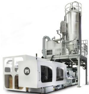
La pressa IPS (Injection Preform System) è servita da due motori elettrici lineari con sistema KERS per il recupero dell'energia cinetica durante la fase di decelerazione. Nel gruppo di plastificazione, il sistema di trasferimento del PET tra estrusore, cilindro di iniezione e stampo è governato da un circuito first-in-first-out che evita l'eccessivo ristagno della plastica all'interno del cilindro, causa di degradazione delle proprietà del polimero.
