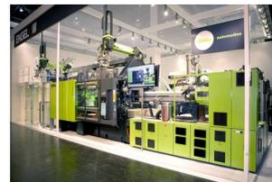
In particolare, una pressa duo 650 combi M stamperà una plancia auto con supporto in materiale termoplastico, strato intermedio in poliuretano schiumato e rivestimento estetico esterno con skin termoformata nello stampo.
