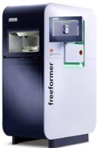
La tecnologia formatura libera di materie plastiche AKF consente di produrre prototipi e piccole serie, senza necessità di realizzare gli stampi. La resina viene scaldata in un cilindro di plastificazione e depositata, strato dopo strato, mediante un ugello che si muove velocemente nell'area di lavoro, attivato mediante tecnologia piezoelettrica ad alta frequenza.
