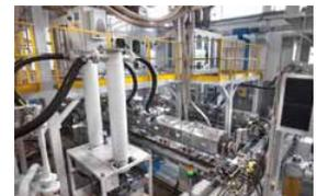
Le linee sono dotate di PLC che gestisce direttamente gli estrusori e la termoregolazione delle teste, mediante rete Profinet; i parametri di produzione e funzionamento degli estrusori sono gestibili in modo centralizzato.
