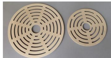
La valvola a piastra è un componente essenziale dei compressori alternativi e ha un impatto diretto sulla loro efficienza ed affidabilità. Quando si utilizza l'acciaio - spiegano in Victrex - in caso di rottura accidentale della valvola le schegge di metallo possono causare danni al cilindro, al pistone e all'anello del pistone; rischio non connesso invece all'utilizzo del PEEK.
