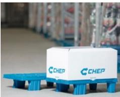
Quarto di Pallet di Chep Italia (foto a sinistra). Pallet in polipropilene riciclato nel formato 600x400 mm (quarto di pallet), pesante solo 1,9 kg, progettato per collegarsi ai display promozionali in cartone ondulato. Riduce gli ingombri del 20% e le emissioni di CO2 del 15% rispetto alla precedente versione da 2,1 kg.
