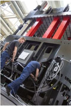
installata presso lo stabilimento BMW di Landshut, dove vengono fabbricati grandi componenti strutturali in compositi plastici fibrorinforzati mediante il processo HP-RTM, che prevede lâ€™iniezione di resine liquide.
