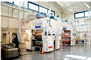
Caratteristica unica del centro italiano è la nuova accoppiatrice Super Combi 3000 (foto a sinistra) fornita da Nordmeccanica, che consentirà ai clienti italiani di ridurre i tempi di fermo legati alla prototipazione, al collaudo e all'usura, oppure di dover arrestare la produzione commerciale per sperimentare nuove soluzioni.
