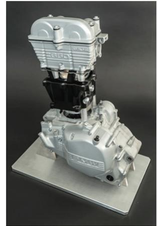
I ricercatori del Fraunhofer Institute for Chemical Technology ICT, in collaborazione con la divisione tecnopolimeri di Sumitomo Bakelite, hanno messo a punto un blocco cilindri in materiale composito fibrorinforzato nell' ambito di un progetto di studio su un nuovo motore monocilindrico. Il componente in plastica pesa il 20% in meno di un blocco di alluminio, con un costo di produzione comparabile.
