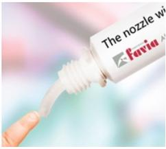
Viene stampato con una pressa bicomponente utilizzando una miscela di polietilene ad alta e bassa densità per la base (più rigida per agganciarsi al tubetto) ed elastomero termoplastico per la punta, morbida e flessibile.
