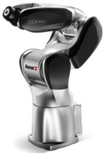
Comau ha lanciato sul mercato il nuovo robot a sei assi Racer 3, con portata al polso di 3 kg e raggio d'azione di 630 mm. Interamente realizzato in leghe di alluminio e magnesio pesa solo 30 kg.
