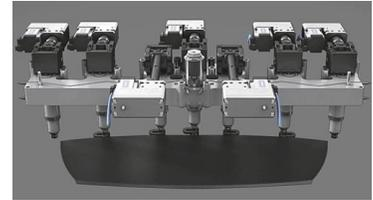
Si tratta di un sistema di otturazione servo-controllata che assicura un controllo preciso, stabile e facile della pressione e del flusso di materiale durante il processo di stampaggio. FLEXflow è stato progettato per controllare in maniera indipendente ciascun otturatore, aggiustando in modo preciso la posizione, l'accelerazione, la velocità e la corsa.
