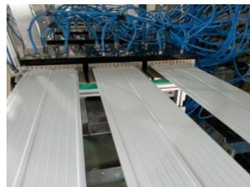
Per raggiungere questo risultato, Bausano ha adottato una linea di estrusione a tripla filiera, così da sfruttare pienamente la capacità produttiva dell'estrusore bivate MD 75/30, ottenendo profili con spessore molto sottile, quindi più leggeri ed economici.
