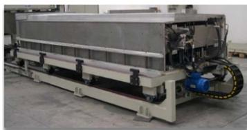
**A BOCCA IN GIÙ.** Per la schiumatura di cabine e armadi frigoriferi è stata sviluppata, per un cliente russo, la tecnologia “maschera di schiumatura a bocca in giù”, composta di un telaio fisso, due pareti laterali e due carri mobili, con maschio versionabile in larghezza (800÷1080 mm), in lunghezza (937÷3.750 mm) e in profondità
