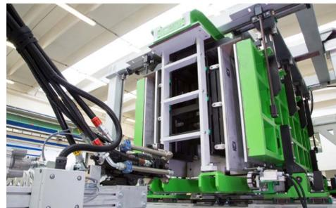
**COME FUNZIONA.** Il sistema di “maschera di schiumatura a bocca in sù” prevede il cambio del maschio in automatico, mentre il fondo della maschera compie un movimento in verticale verso il maschio, grazie a cilindri elettromagnetici azionati da motori “brushless”.
