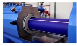
Per applicazioni in edilizia, in particolare condutture per l'adduzione di acqua calda e lo scarico insonorizzato, sono in commercio tubi multistrato in polipropilene rinforzato con fibra di vetro e cariche minerali (carbonato di calcio o solfato di bario). Le fibre, in questo caso, migliorano le proprietà elastiche e meccaniche della resina, consentono di ridurre lo spessore dei tubi, mantenendo lo stesso livello di
