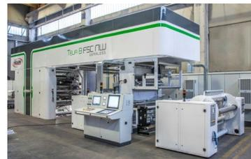
Telia 8 FSC combina il sistema FSC (Fast Sleeve Change) per il cambio rapido degli sleeves con la tecnologia Gearless. La macchina viene ora fornita nelle versioni con fascia larga o stretta.
