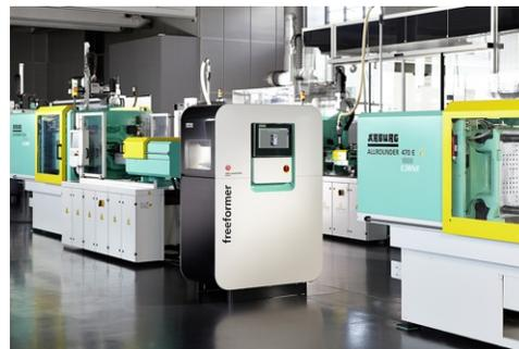
Il riconoscimento a chi ha portato un contributo all'innovazione tecnica in campo industriale è stato assegnato al costruttore tedesco per freeformer, processo innovativo di manifattura additiva che fonde la stampa 3D con la possibilità di utilizzare i normali granuli di materiale plastico, più economici e versatili dei materiali specifici per le tecnologie additive e facilmente reperibili sul mercato.
