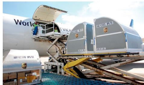
**CON FIBRE ARAMIDICHE.** I container MacroLite ULD, già testati da UPS, sono più leggeri e possiedono una vita utile più lunga rispetto alle unità in alluminio, che rappresentano lo standard per il trasporto aereo, dove ogni chilogrammo di tara rappresenta un kg in meno di carico utile.
